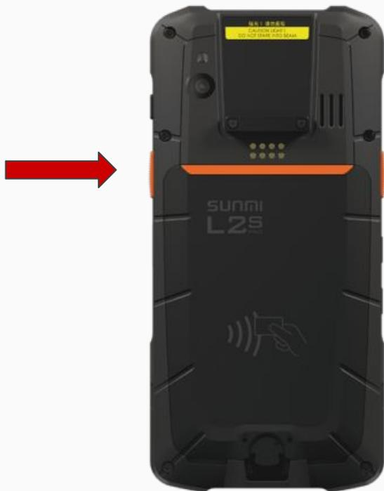
**IMPORTANTE:** Per facilitare lo scambio di dati tra il vostro dispositivo ed QR Code del cliente è consigliabile **usare** il pulsante arancione situato sul lato del dispositivo (FIG.5)
